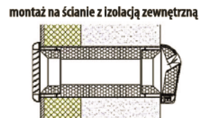
RYS. 7 przekrój montażowy na przykładzie SC EM A (ściana o szer. 300 mm)
