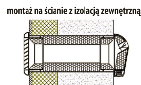
RYS. 7 przekrój montażowy na przykładzie SC EM HY (ściana o szer. 300 mm)
