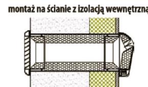
RYS. 7 przekrój montażowy na przykładzie SC EM A (ściana o szer. 300 mm)
